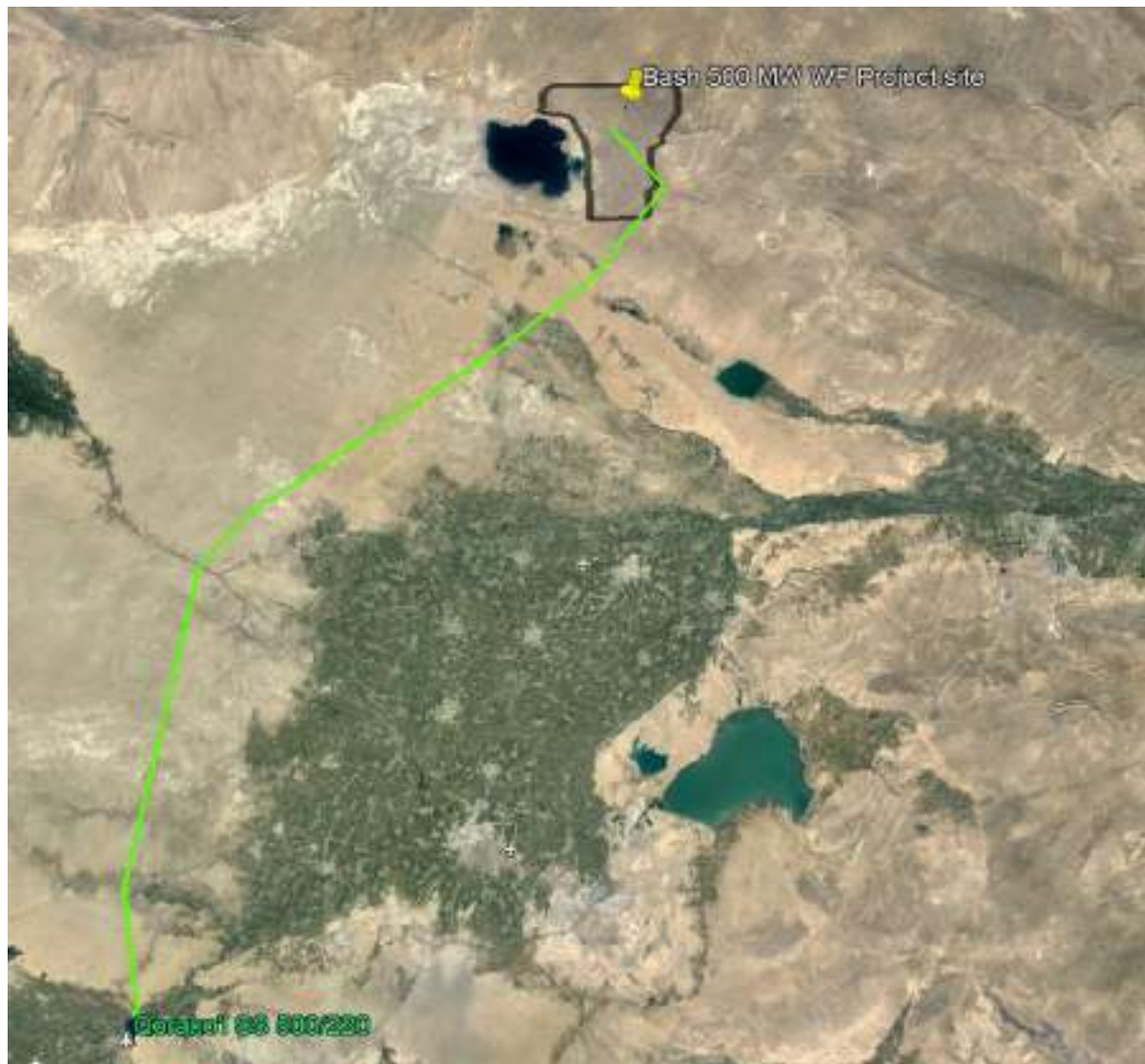
Рисунок 2-2. Схема расположения ВЛЭП протяженностью 162 км от ветряной электростанции Баш до подстанции Каракуль
