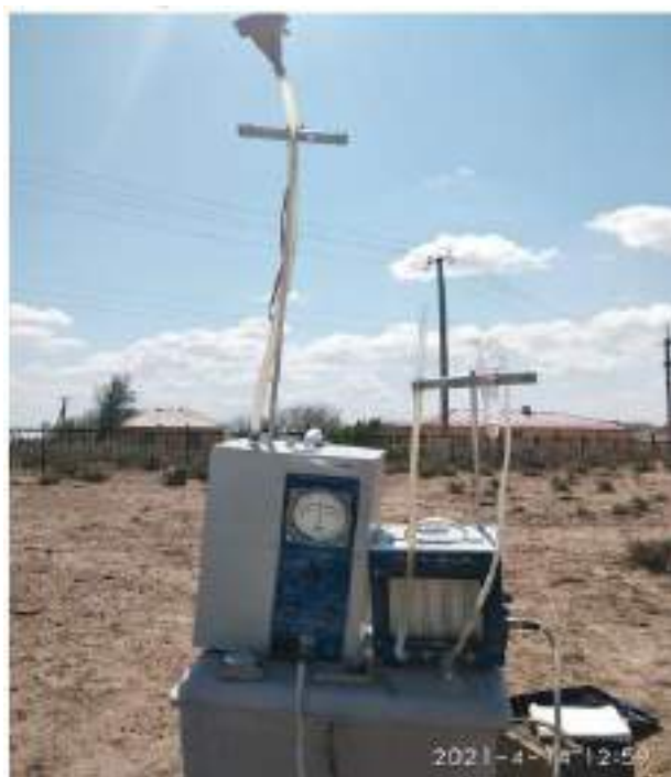
Фото 8-1 Прибор для мониторинга качества воздуха, используемый для мониторинга на площадке Проекта
