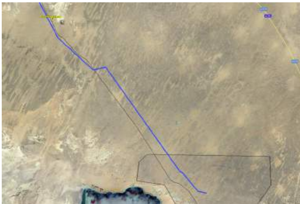
Рисунок 2-12 Предлагаемый маршрут ВЛЭП пересекает существующую железнодорожную линию (синим цветом указан маршрут ВЛЭП, черным - железнодорожная линия)
