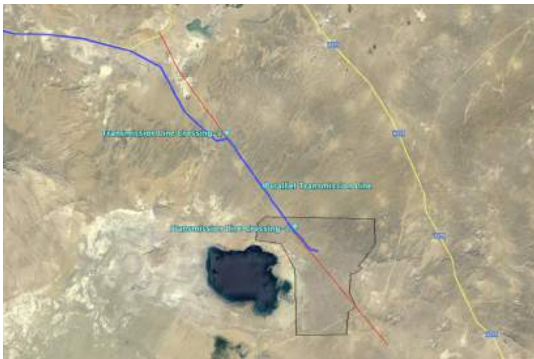
Рисунок 2-12 Предлагаемый маршрут ВЛЭП пересекает существующую железнодорожную линию (синим цветом указан маршрут ВЛЭП, черным - железнодорожная линия)
