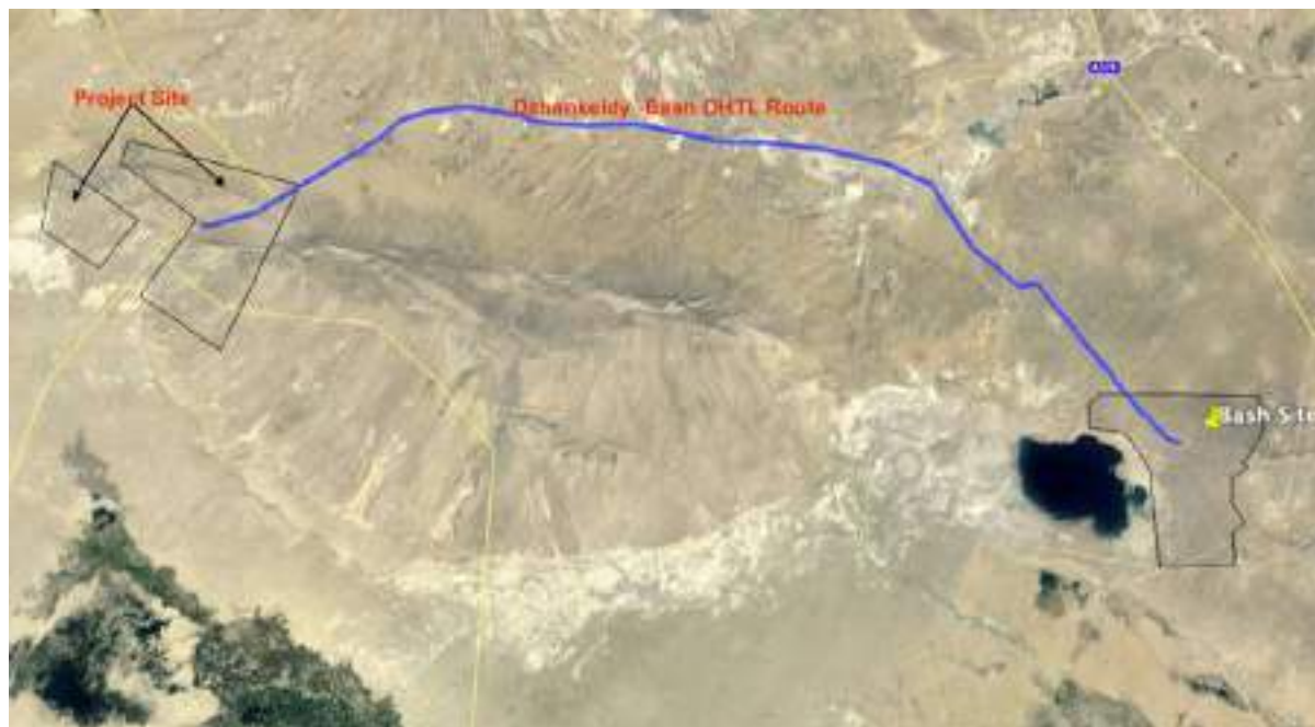
Рисунок 2-3 Расположение ВЛЭП протяженностью 128,5 км от ветряной электростанции Джангельды до площадки Баш
